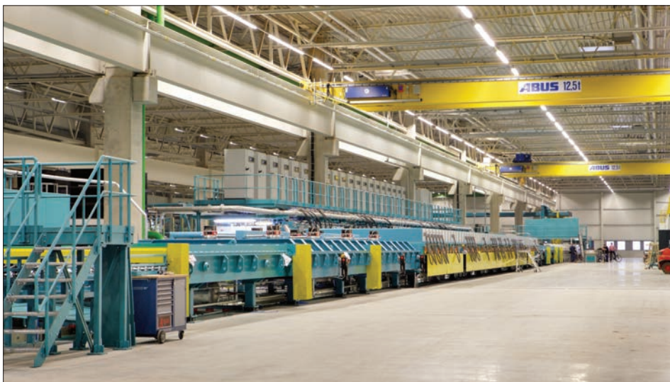
Magnetronspattern im Vakuum.
